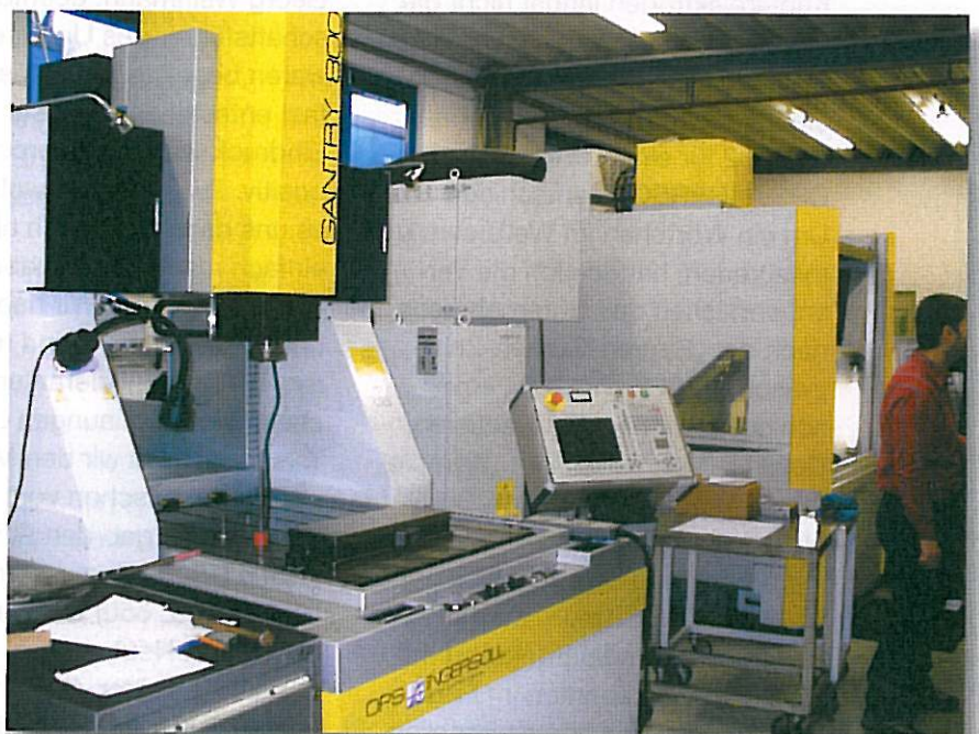
Bild 5: Nach der HSC-Fräsmaschine wurde innerhalb kürzester Zeit in eine Senkerodiermaschine Gantry 800 investiert. (Werkbilder: Möderer Werkzeug- und Formenbau, Leinburg)
