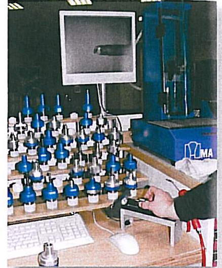
Bild 2: Der erste Blickkontakt entscheidet: Die Kontrolle der Schneidkontur erfolgt innerhalb von Sekunden
