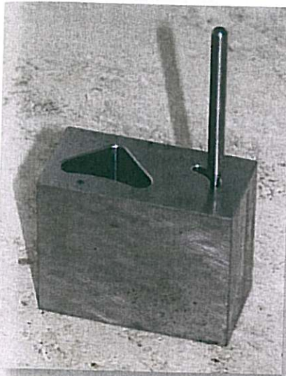
Bild 7: Kommt es zu Taschen oder muss tief gefräst werden, fährt der Fräser ohne Mediumverteiler zwangsweise über den Span und bricht
