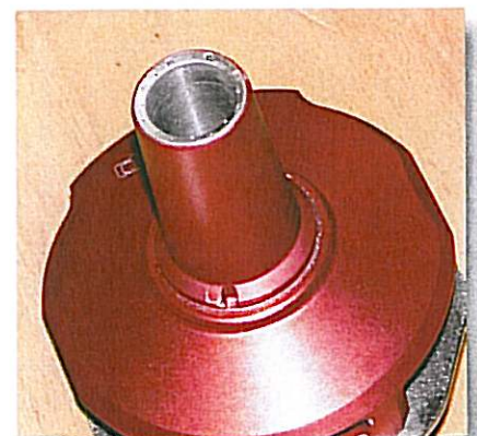
Bild 3: Die Bohrungen sind in unterschiedlichen Winkeln im Düsenkörper eingebracht, so strömt die Luft/Medium ringförmig direkt an die Schneide
